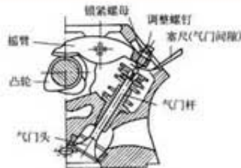
图2 上置摇臂式配气机构的气门间隙
