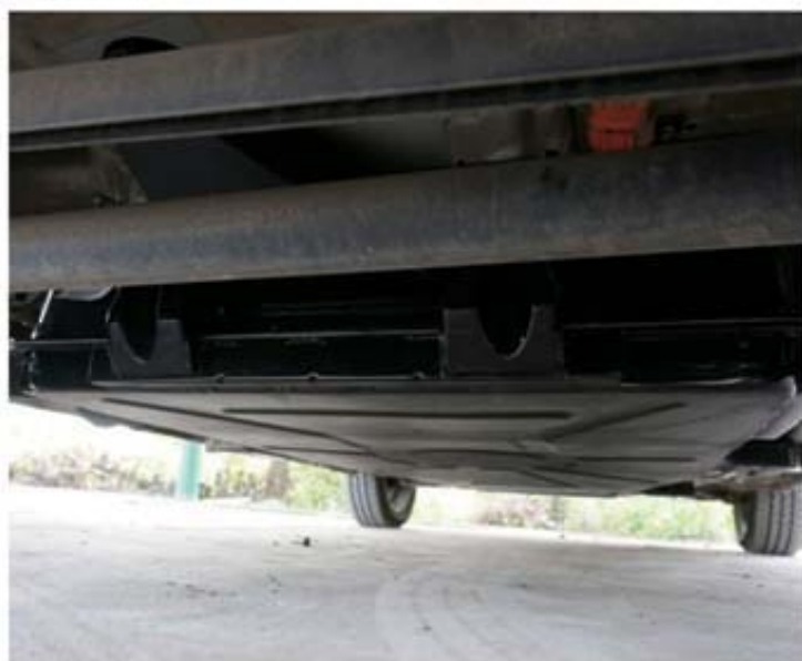
「奇瑞 eQ 整个电池组模块被安置在车底」
