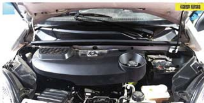
动力方面，E30L配备了16kW的永磁直流电机，18kWh的磷酸铁锂电池组容量并不算高，但因为整车质量的大幅降低，使得E30L的续航里程可以达到160km。能够在30分钟完成快充，慢充也只需要8小时。电池循环寿命可达1500次；并且采用高温充电，容量稳定且储存性能良好。
