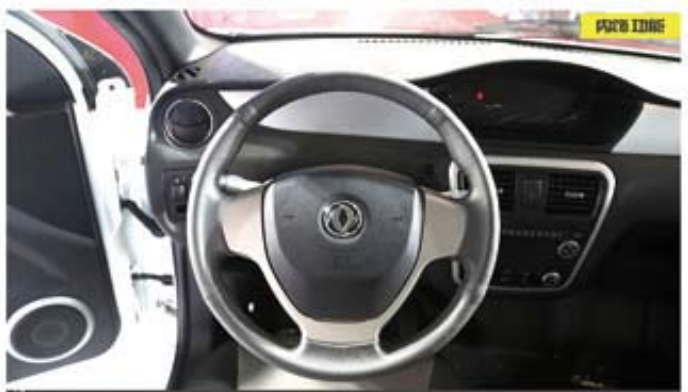
中控台整个仪表台是悬浮式结构，可以扩大下部空间。同时还配置了自动恒温空调，而多媒体系统比较简单，并不支持CD播放，配置了USB接口，可以满足U盘播放多媒体音乐。
