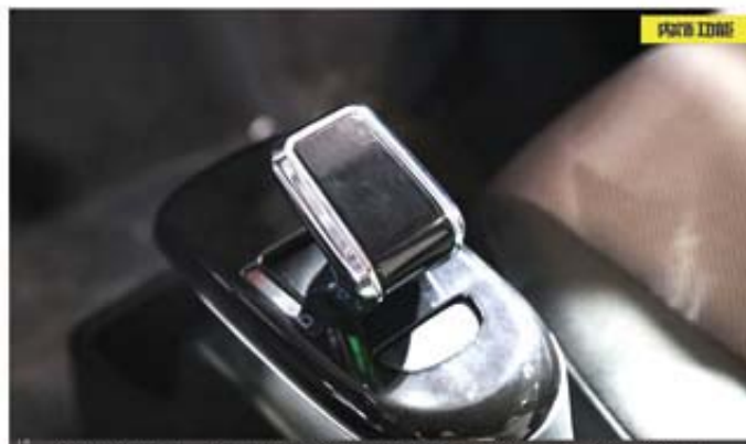
该车配备有换挡杆，造型相当别致。变速杆杆实际上只是停车、行驶、倒车三个模式开关。
